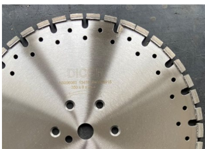
Fugentechnik / Induktionsschleifen, breit 6, 8 oder 10mm Asphalt für Trockenschnitt, doppelverzahnt
