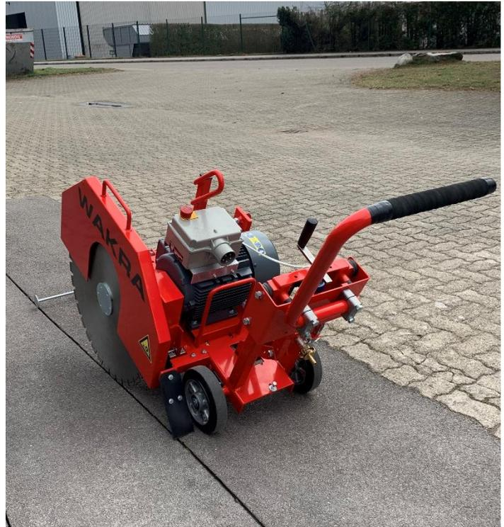
Sehr kompakter und für seine Klasse leichter Elektro-Fugenschneider für Sägeblattdurchmesser bis max. 700 mm, beidseitig und wandbündig.
